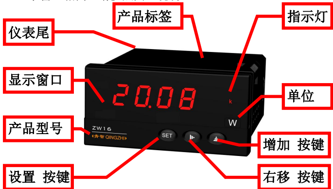
图 2 ZW16 单参数仪表图示
